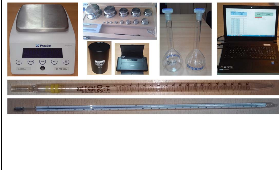
Slika: Oprema koja se koristi za kontrolu pretpakovanih proizvoda
